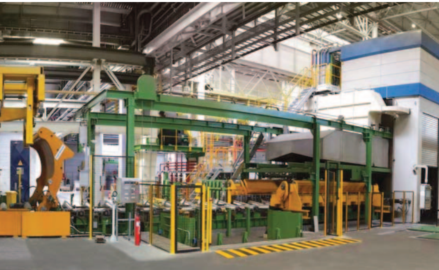
Νέο τετραπλό θερμό έλαστρο αλουμινίου (Tandem) κορυφαίας τεχνολογίας
